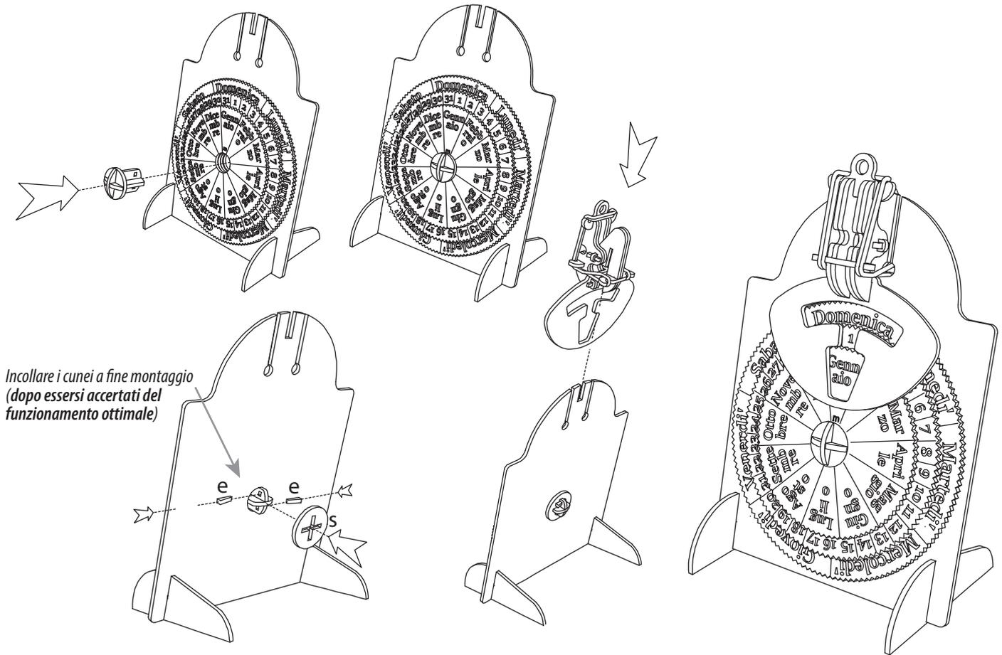
**Incollare i cunei a fine montaggio (dopo essersi accertati del funzionamento ottimale)**
